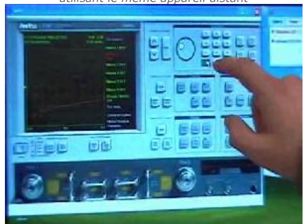
Elève utilisant l'interface graphique virtuelle d'un analyseur de réseau situé dans un local distant
